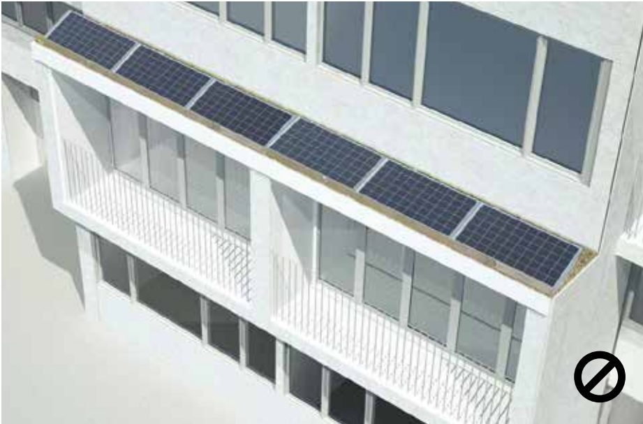
Solceller på mindre tagflader er ineffektive og anbefales ikke.
